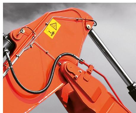
Машина адаптирована к эксплуатации в условиях сильной запыленности путем увеличения диаметра точки смазки соединительного элемента рукояти.
