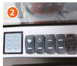
ЦЕНТРАЛЬНЫЙ БЛОК ВЫКЛЮЧАТЕЛЕЙ
