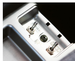
КНОПКА АВАРИЙНОГО ОСТАНОВА ДВИГАТЕЛЯ
